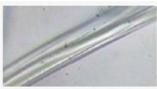
圣麻纤维显微镜下纵向形态图片
